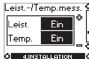
Рис. 9. Выбор функции измерения мощности или температуры.
