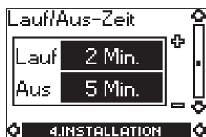
Рис. 7. Установка максимального времени работы и отключения насоса при откачивании грунтовых вод. Максимальное время работы и отключения насоса можно установить на дисплейном изображении, показанном на рис. 7.
