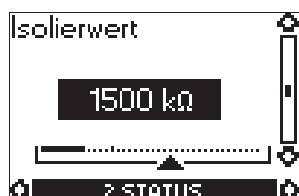
Рис. 6. Величина сопротивления изоляции относительно земли.
