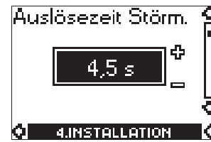
Рис. 2. Установка времени отключения для всех аварийных сообщений.
