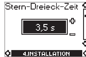
Рис. 3. Установка времени включения электродвигателя в соединение звездой и в соединение треугольником.
