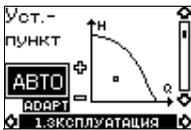
Требуемое заданное значение может устанавливаться путем нажатия кнопок "+" и "-" на клавиатуре прибора R100 (это сделать невозможно, когда насос находится в режиме регулирования "AUTOADAPT" (автомат.)).
