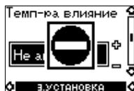
**Внимание:** Если управление насосом осуществляется в соответствии с постоянной характеристикой или выбран способ регулирования "АУТО<sub>АДАПТ</sub>" (автомат.), то регулирование по температуре с помощью прибора R100 невозможно.
