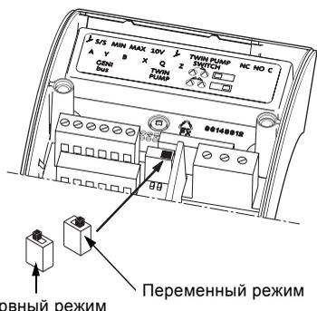
Рис. 9 Коммутационная перемычка
