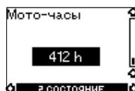
Количество мото-часов эксплуатации насоса.
