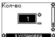
Здесь можно присваивать насосу номер от 1 до 64 или, соответственно, менять имеющийся у него номер, чтобы прибор R100, система управления Pump Management System 2000 фирмы Grundfos или аналогичные устройства могли отличать один насос от другого.
